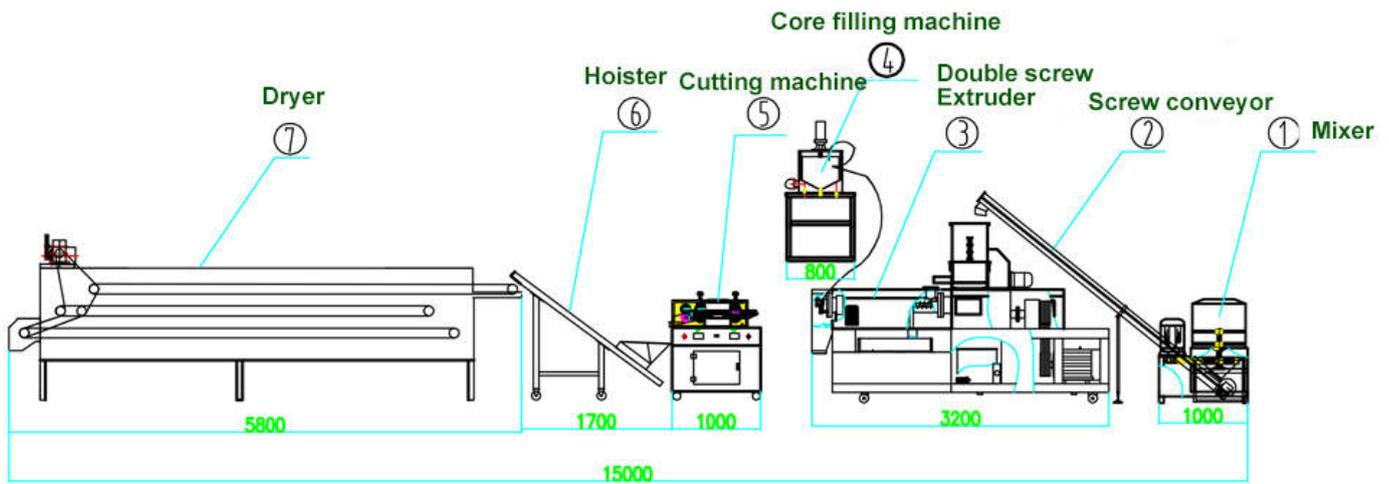
Sistema de mezcla --- Sistema de extrusión ---- Sistema de corte --- Sistema de secado --- Sistema aromatizante
