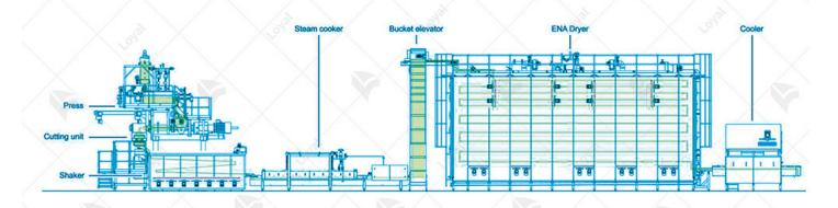
RAW MATERIAL HANDLING—VACUUM EXTRUDER SHAPING—PRE-RIPENING—PRE-DRYING—DRYING—COOLING—PACKING
